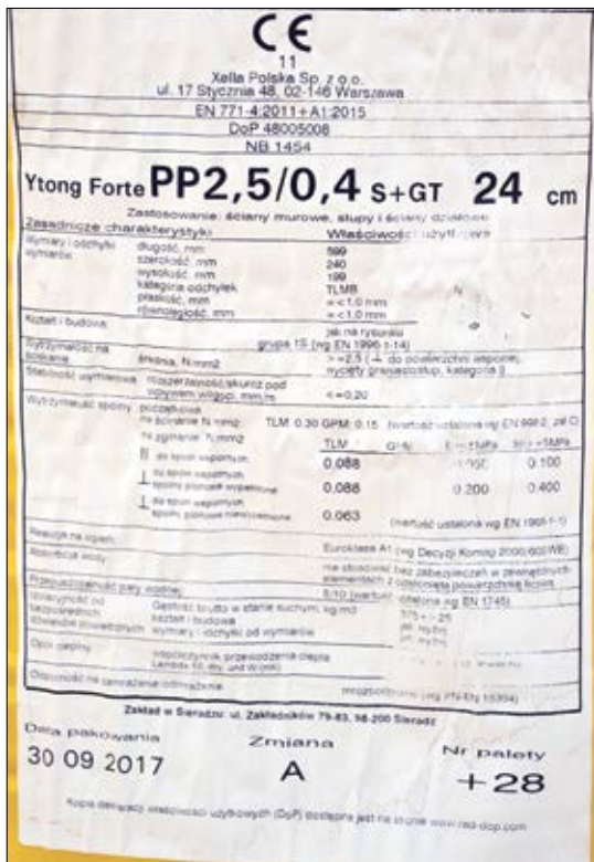
Zobrazowanie przykładów dwóch różnych sposobów archiwizowania Deklaracji Właściwości Użytkowych wyrobów budowlanych: dokumentacja fotograficzna deklaracji widniejącej na opakowaniu produktu wykonana na placu budowy (grafika po lewej stronie), dokumentacja w formie deklaracji papierowej lub elektronicznej pobrana ze strony producenta wyrobu (grafika po prawej stronie).
